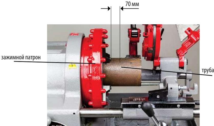
Поднимите труборез (1), резьбонарезную головку(2) и гратосниматель (3) так, чтобы они не мешали. Введите обрабатываемую деталь через центрирующий зажимной патрон (7) и затяните его.
