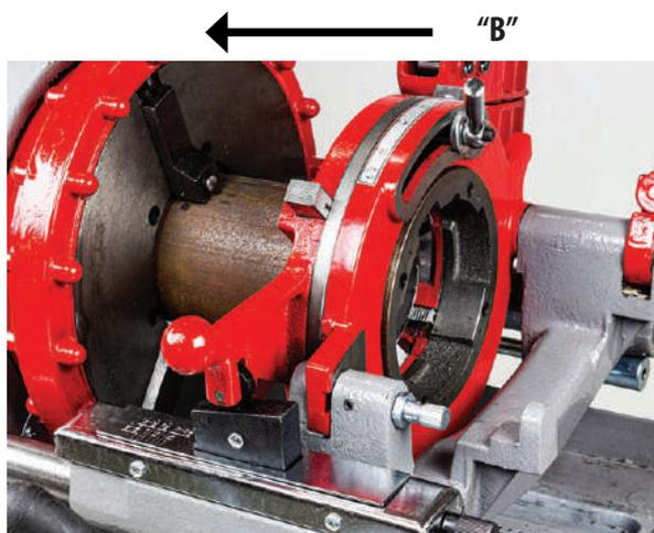
Включите станок, поворачивайте маховик по часовой стрелке, чтобы резбонарезные ножи прижались к обрабатываемой детали.
