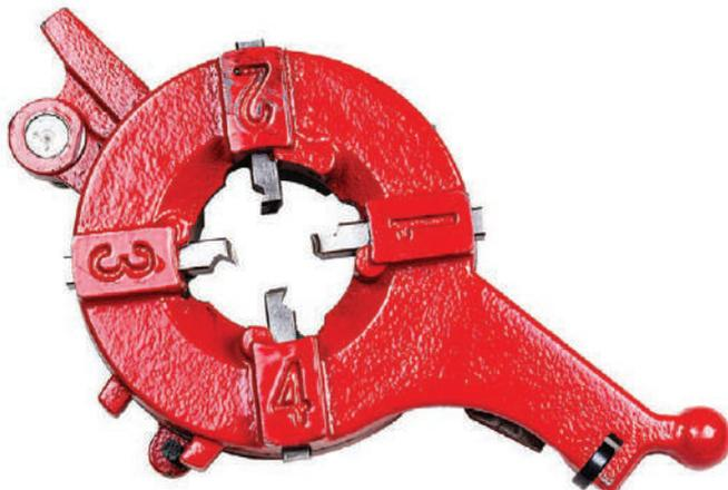
ее на горизонтальную плоскость цифрами вверх. Повернуть рукоятку против часовой стрелки до упора. Вытащить ножи.
