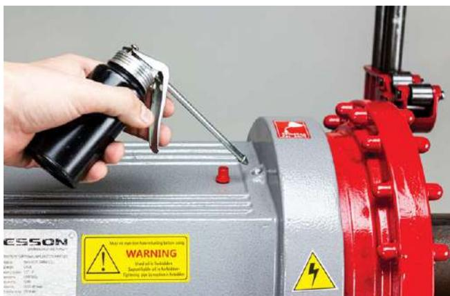
кратное 1-2 мл! Частота заливки масла (смазывания) зависит от объема и интенсивности выполняемых работ.
