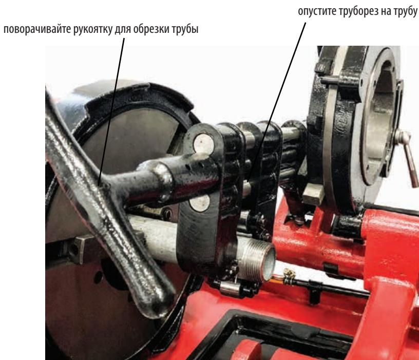
Не скапливайте обрезки труб в поддоне. Удаляйте их непосредственно после завершения процесса обрезки трубы и остановки электродвигателя станка.
