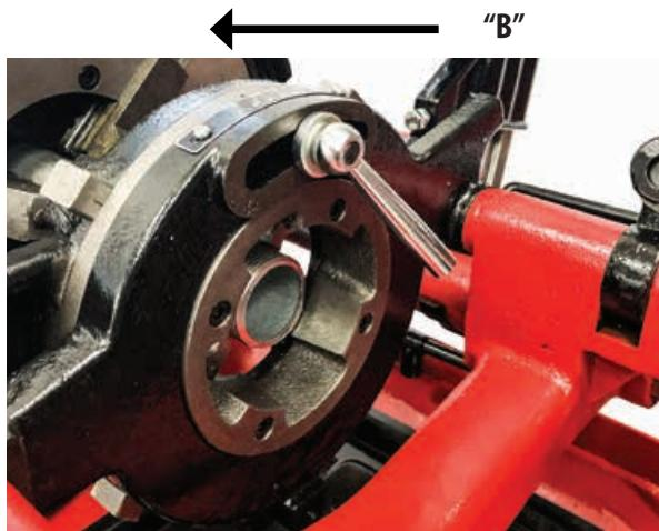
Включите станок, поворачивайте маховик по часовой стрелке, чтобы резьбонарезные ножи прижались к обрабатываемой детали.
