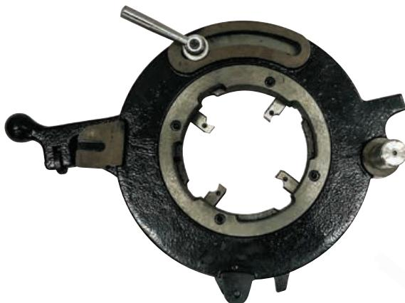
ее на горизонтальную плоскость цифрами вверх. Повернуть рукоятку потив часовой стрелки до упора. Вытащить ножи.
