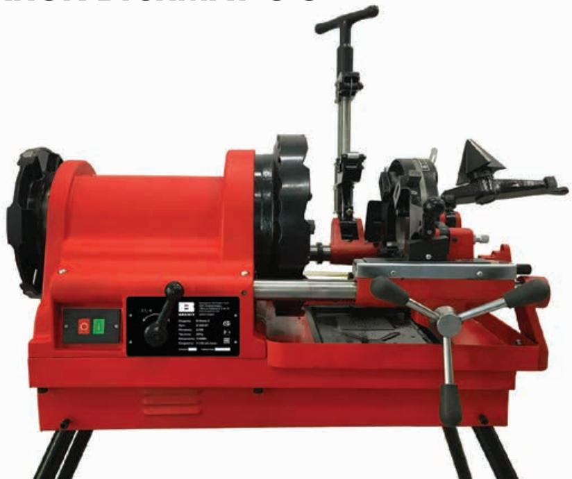
Резьбонарезной станок предназначен для нарезания наружных трубных конических (BSPT, 1/2 - 3") резьб на стальных трубах.
