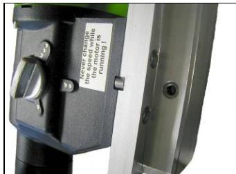
Zum Lieferumfang gehört eine Montageplatte, eine Passfeder 10 mm und 4 Innensechskantschrauben M8 x 20. Die Montageplatte wird mit der Passfeder auf die Maschine aufgesetzt und mit den vier Schrauben befestigt.
