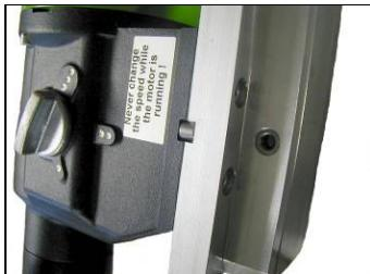
Le support est livré avec une plaque de maintien, un ressort d'ajustage 10 mm et 4 vis à tête creusent M8x20. La plaque de maintien se fixe sur l'outil à l'aide de la clé de telle manière à ce que l'accouplement soit du même coté que du sélecteur de vitesse. Puis insérez et vissez les 4 vis.
