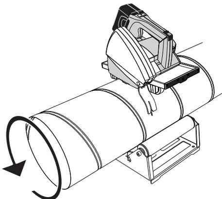
Когда труба отрезана, нажмите кнопку UNLOCK вперед, чтобы была видна желтая метка и снимите блокировку (рис. L). После этого поднимите моторный блок в исходное положение. Выключите выключатель питания. Убедитесь в том, что подвижное нижнее ограждение диска опущено в безопасное положение (рис. M).
