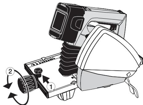
Если следовать шкале Pipe Cut, то глубина резания обычно составляет от 5 до 10 мм, если Pipe Cut зафиксирован в правильном положении резания. В заключение зафиксируйте регулировку предохранительным винтом, чтобы отрегулированное положение не изменялось во время резки.
